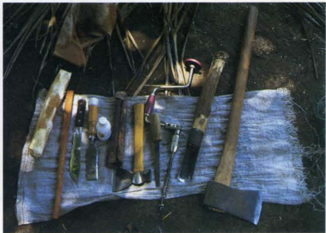
↑ガラオン職人の工具。丸太をくり抜く大丸ノミ(右から2番目)は職人みずから水道管からつくったものだ
